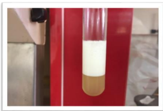
شکل (۴): سنجش ظرفیت امولسیون کنندگی نفت خام و گازوئیل
